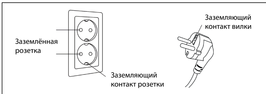
Рисунок 13 — Правильное заземление массажного кресла
