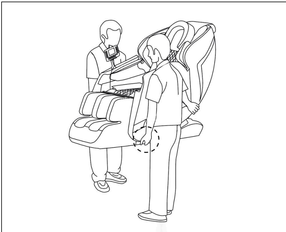
Рисунок 5 — Перемещение массажного кресла без использования транспортировочных роликов
